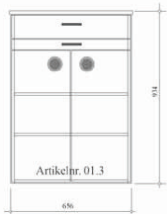
Schrankaufbau mit 1 Schubkasten, 1 auszieh. Schreibplatte sowie 2 Türen und 2 verstellb. Einlegeböden
