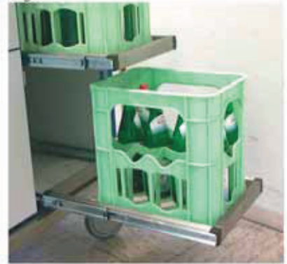
Auszug für Getränkekästen Edelstahlrahmen aus Rechteckrohr mit einge- setzten Querstäben aus Edelstahl. Kugellauflauszug, Belastbarkeit 45 kg
